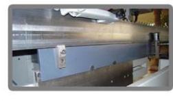
Механизм поднятия пилы с помощью двигателя
